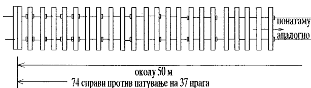
Слика 8 - Положба на направите против патување на шините кај колосек заварен во ДШЛ.
