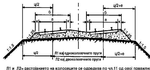
Слика 20 - Напречен пресек на засторна призма кај двоколосечни и паралелните пруги со дрвени прагови, во кривина.
