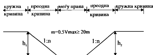
Слика 38 - Меѓуправа меѓу рампите за надвишување.
