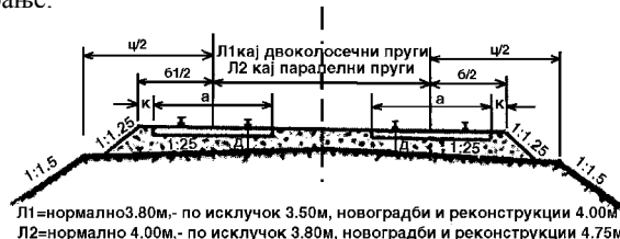
Слика 19 - Напречен пресек на засторна призма кај двоколосечни и паралелни пруги со дрвени прагови, во правец.
